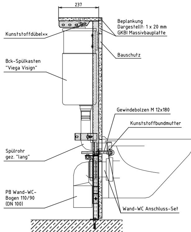
Einbau in Trennwand oder Vorwandinstallation (Montagesatz Modell-Nr. 188.003.20 bitte mitbestellen)
